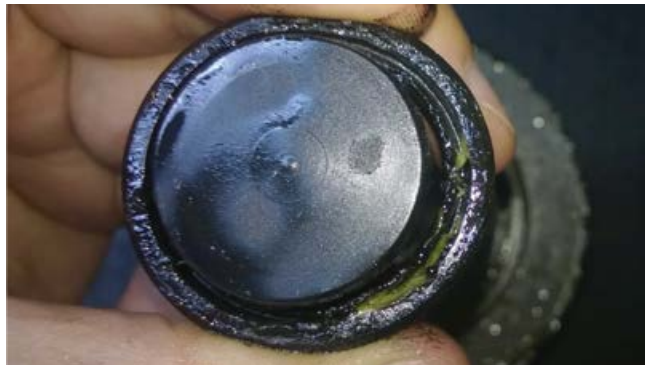
O-ring spęczniały w wyniku działania niewłaściwie zastosowanego medium roboczego
