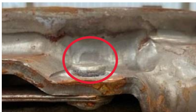
Produkt różniący się od SACHS – śruba znajduje się zbyt wysoko.
