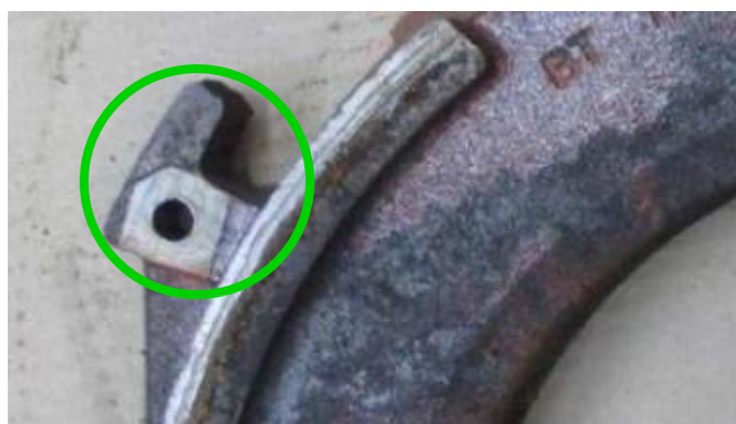
Kompletny otwór instalacyjny
